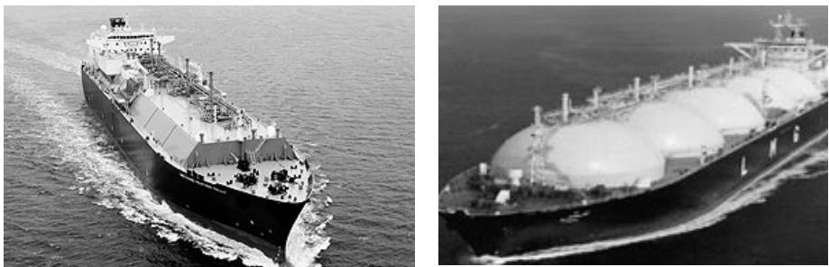
**Figura 3.** Buques tanques, especialmente diseñados para transportar, en forma segura, grandes cantidades de Gas Natural Licuado.
